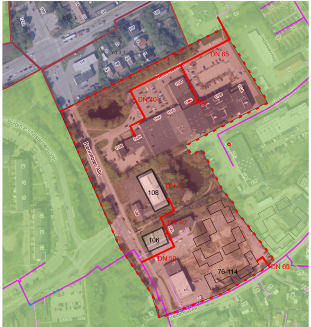
Figur 2 Fjernvarmeforsyning af projektområdet – røde linjer: nyt planlagt ledningsnet, lilla linjer: eksisterende fjernvarmenet.
